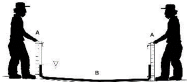
Figura 4. Obtención de un perfil microtopográfico con mangueras de nivel.
